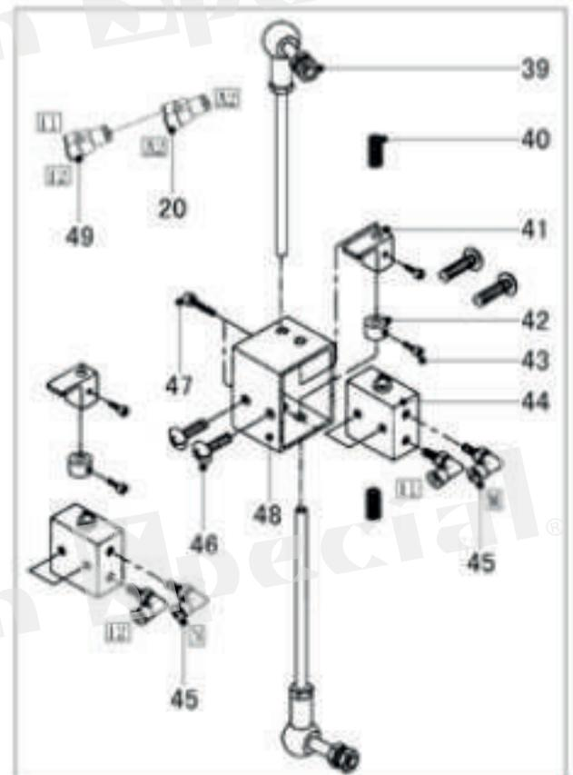
PB-气动功能装置B Pneumatic device B
