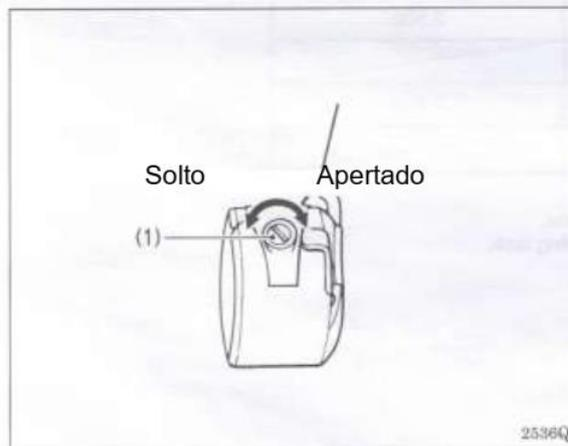
Ajuste a tensão da linha da bobina através Do parafuso (1)
