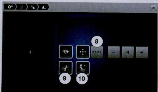
O número e tipo de pontos de arremates da tecla «Fim do padrão/Arremate» podem ser programados.
