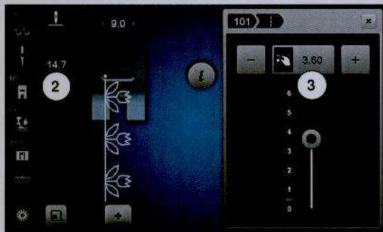
Em outro padrão de ponto, incluindo alfabetos, o comprimento total do padrão de ponto **2** é mostrado. O comprimento atual do ponto **3** somente é visível quando a Tela de comprimento do ponto é aberta.
