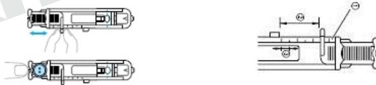
As marcas no calcador tem escala de 5 mm (3/16 inch). A escala do calcador é o comprimento do caseado (diâmetro + espessura do botão). O tamanho da casa é programado.
